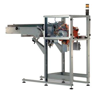
È un dispositivo presa e posa rotativo, collegabile in fase meccanica con macchine confezionatrici o equipaggiato con motorizzazione propria, per distribuire prodotti come coupons o tessere, con una velocità fino a 400 pezzi/minuto. I prodotti vengono prelevati da un magazzino di carico tramite delle ventose.
