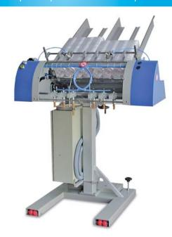
Il sistema è disponibile interamente in acciaio Inox e alluminio anodizzato, con doppio magazzino di carico per vaschette a fondo piatto o alveolari. È movimentato da un motore Brushless e raggiunge una produzione di 160 pz/min a 80 cicli. Progettato per essere integrato sulle confezionatrici Flowpack, o come alimentatore dei nastri trasportatori che convogliano al riempimento manuale.
