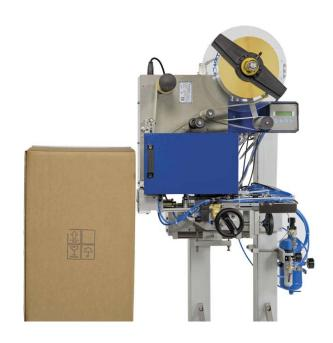
Questo modello di print & apply stampa e applica le etichette sulla parte laterale o superiore dei prodotti grazie ad uno speciale tampone pneumatico, con corsa utile di 30 mm, che permette l'applicazione a più di 10 mm di distanza, su prodotti fermi o in movimento, anche con superficie irregolare.
