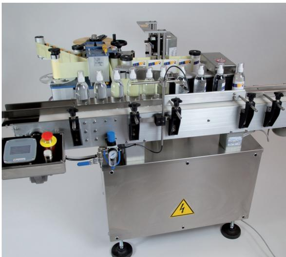
Soluzione compatta e funzionale per assicurare una perfetta etichettatura dei prodotti cilindrici. Il dispositivo DRP permette la rotazione del prodotto facendolo ruotare su se stesso durante la fase di etichettatura. Le ridotte dimensioni facilitano l'inserimento in qualsiasi ambiente.
