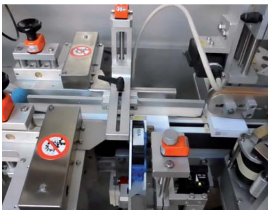
Doppio nastro di trasporto a cinghia dentata con spintori a trasporto positivo
