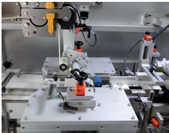
Cinghie laterali motorizzate contrapposte (lanciatori)
