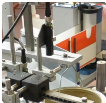
Uno speciale dispositivo magnetico assicura che la maniglia resti alzata durante la rotazione. La presenza di una fotocellula permette di orientare correttamente l'etichetta rispetto al prodotto.
