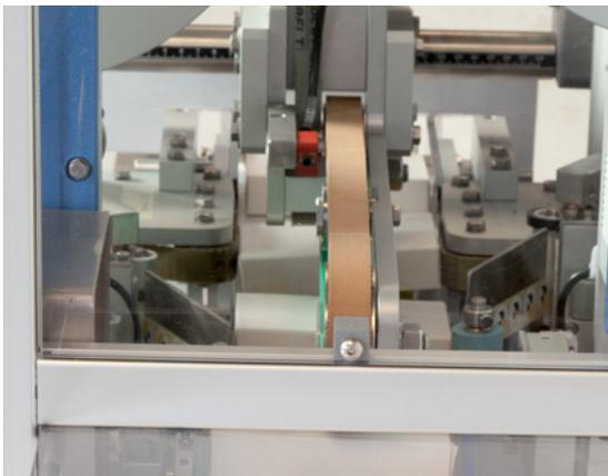
Coppia di nastri laterali motorizzati di distanziamento prodotti con microregolazioni e scale millimetriche
