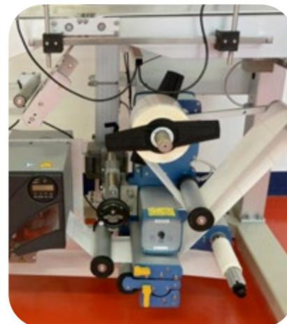
L'etichettatrice superiore è equipaggiata con un terminale di distribuzione lungo regolabile, per la separazione dalla carta di supporto e l'applicazione di un'etichetta di **dimensione 20 x 40 mm**.
